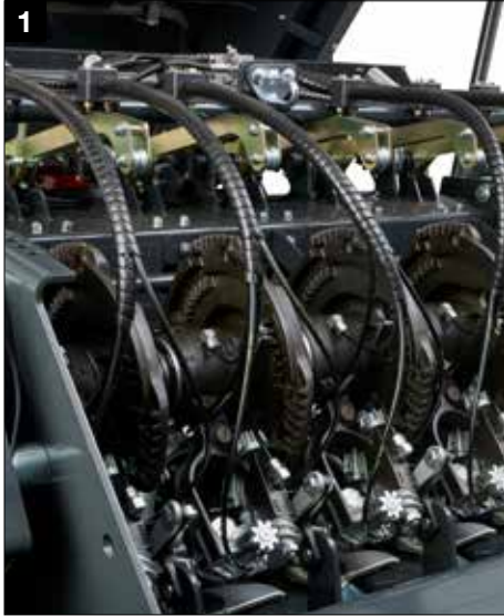
Doppelknotersystem mit serienmäßiger elektronischer Überwachung
