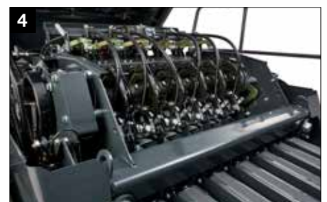
Doppelknotersystem mit serienmäßiger elektronischer Überwachung
