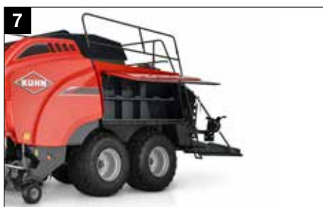
Leicht zugängliche Garnkästen für 2 x 16 Garnrollen
