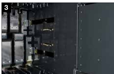
Austauschbare, verschleißfeste Komponenten im Presskanal
