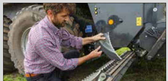
Einseitig ausschwenkbare Messerkassette
