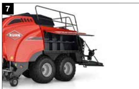
Leicht zugängliche Garnkästen für 2 x 16 Garnrollen
